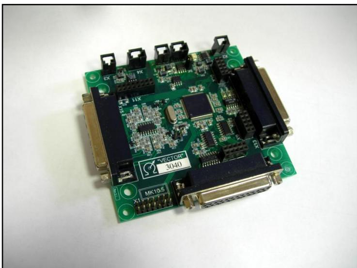
**Назначение:** Системы управления «Умными домами», системами вентиляции, встраиваемые системы управления преобразователей частоты, источников питания, комплектных электроприводов с двигателями любых типов.
