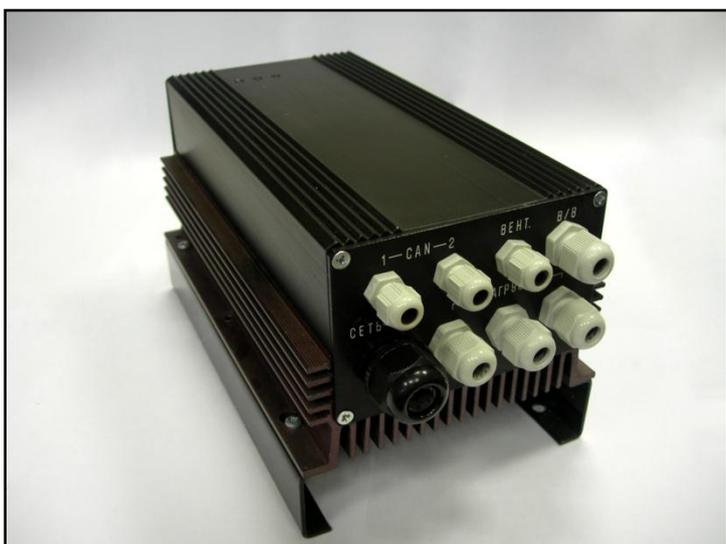
**Назначение:** «МИРН» – универсальное устройство предназначено для применения в широком спектре областей: для автоматизации и системы управления освещением, вентиляцией, климатом в помещениях, для встраивания в системы интеллектуальных домов, для плавного пуска асинхронного и синхронного двигателей и других задач, где есть необходимость регулирования мощности на нагрузке.
