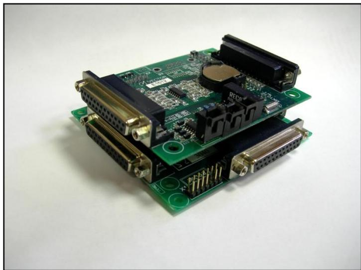
**Назначение:** Плата расширения МК10.5Е обеспечивает расширение функциональных возможностей контроллера МК10.5. Плата расширения может использоваться для решения задач комплексной автоматизации системы управления на базе контроллера МК10.5 с интерфейсами RS-232 и RS-485, разработки систем реального времени, разработки векторной системы управления с использованием импульсного датчика положения, обеспечения независимой работы двух 6-ключевых инверторов напряжения и для других целей.
