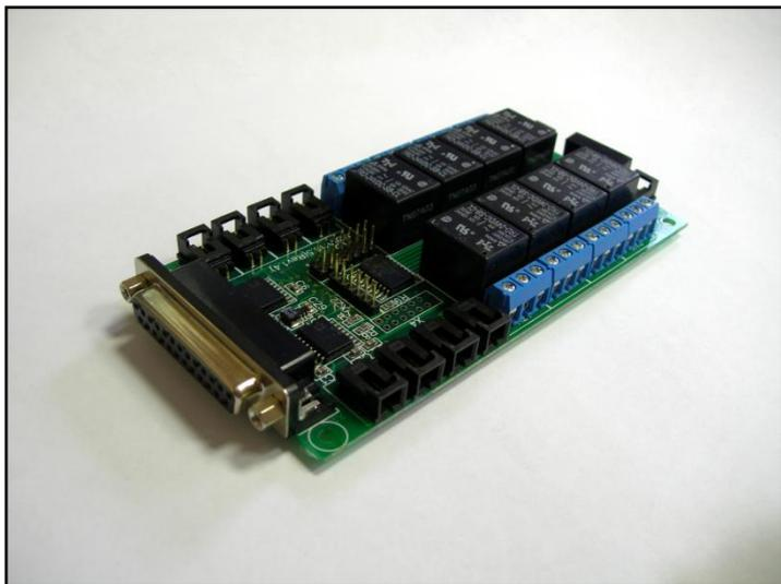
**Назначение:** Модуль ввода-вывода МДВВ 10.5 с последовательным синхронным интерфейсом SPI предназначен для организации ввода и вывода дискретных сигналов во встраиваемых системах управления электрическими двигателями.
